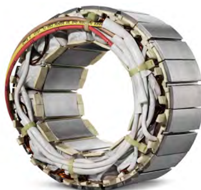
Silnik IE4 systemu Concertor jest krótszy i bardziej zwarty niż konwencjonalne silniki ze względu na skoncentrowane uzwojenie stojana.
