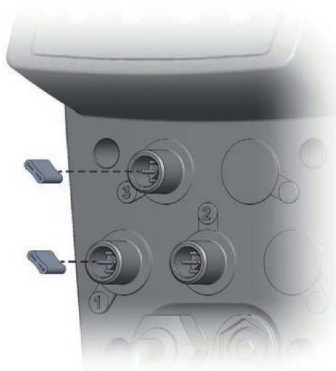
Ilustr. 9-1: Usunięcie giętkich przewodów elektr.
