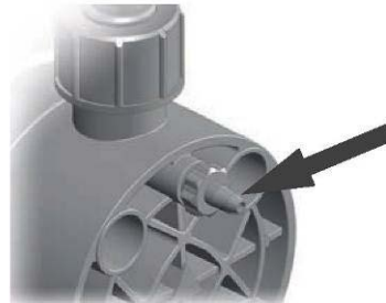
Ilustr. 8-7: Odpowietrzanie głowicy dozującej z przyłączem do węża
