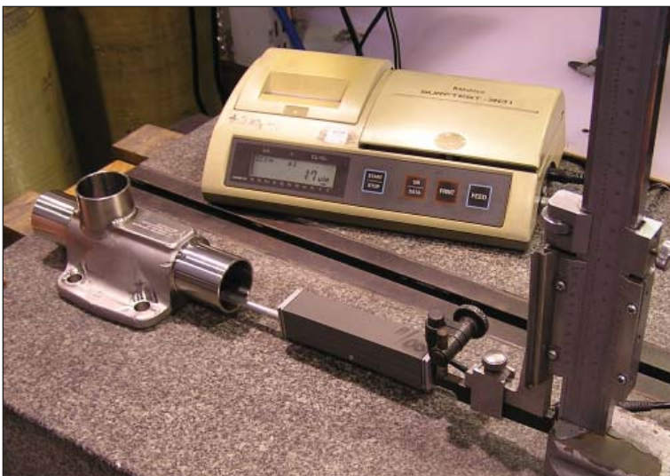
Badanie jakości powierzchni zaworu za pomocą profilometru
