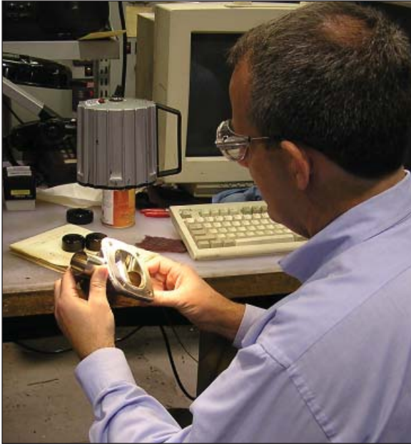
Badanie jakości powierzchni zaworu za pomocą profilometru
